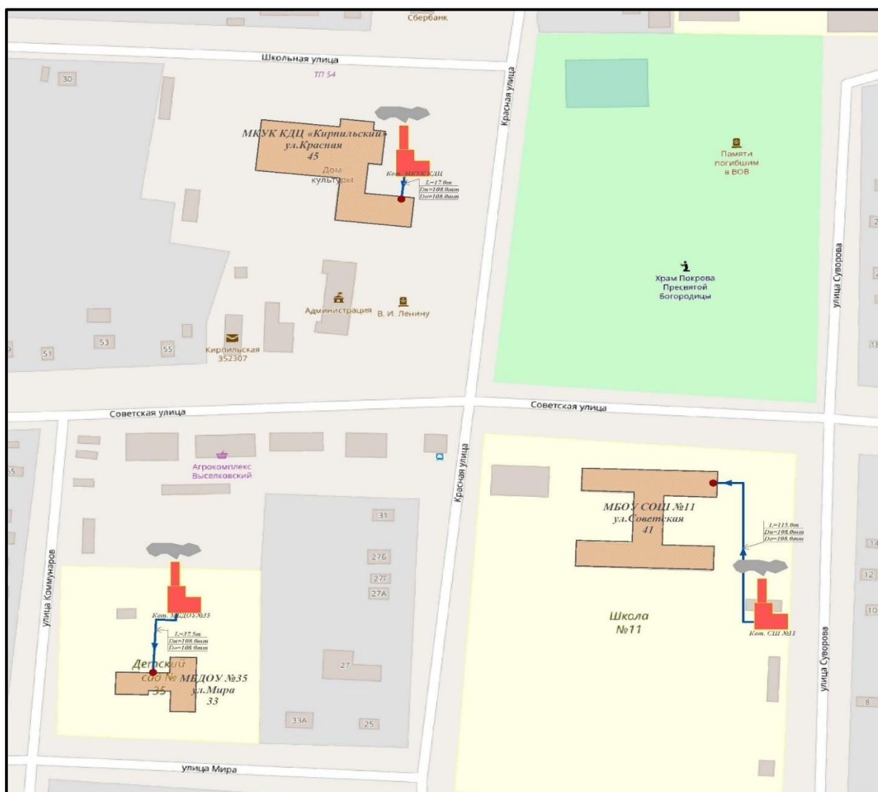
Рисунок 3.1.1 – Графическое представление объектов системы теплоснабжения Котельной
