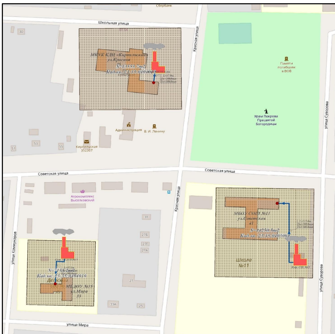
Рисунок 4.1 – Зона действия отопительных котельных
